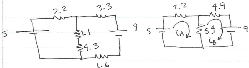
$$\text{Loop A: } 5 = 2.2i_A + 5.4(i_A - i_B)$$
